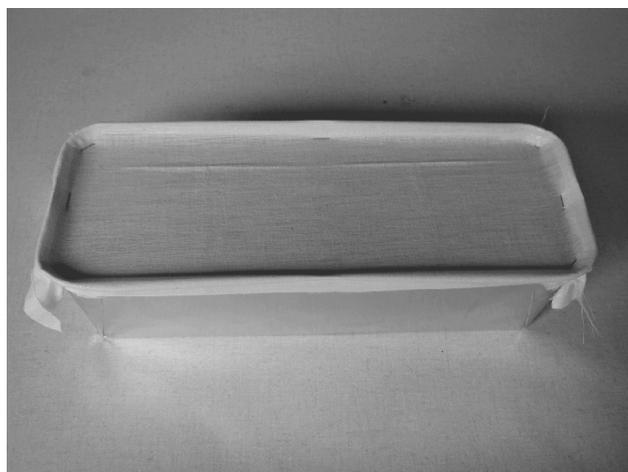
Abbildung 1: Vorbereitete Bodenprobe in Aluschale mit Gazebinde zugedeckt
