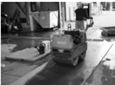
Un échantillon sous un compacteur vibrant
