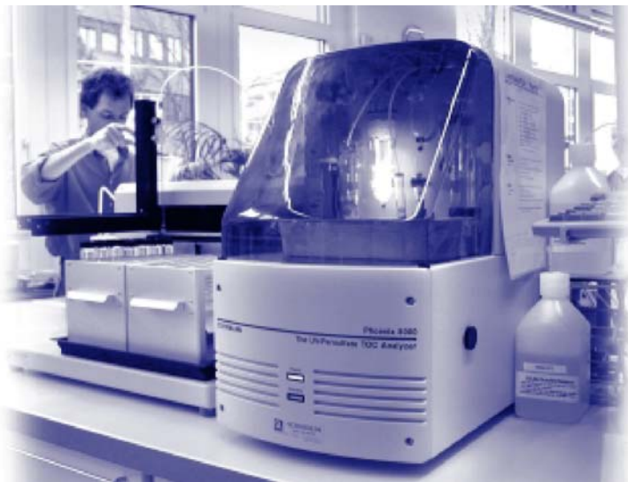
Figur 2: Messung des DOC im Trinkwasser erfolgt mit chemischer Oxidation und anschliessender Infrarot- Detektion.
