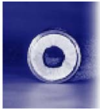
Figur 1: stark verkalkte Trinkwasserleitung
